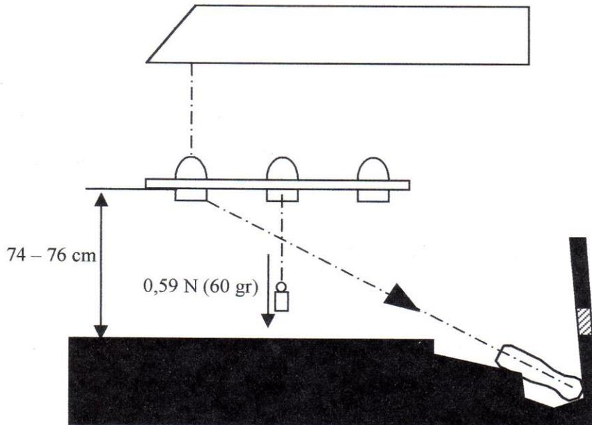
Accrocher un poids après les cordes. La résistance ne doit pas être supérieure à 50 gr +/- 20 gr.
